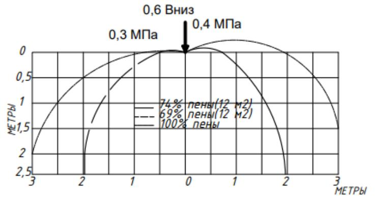
**Графики зависимости интенсивности орошения от давления для оросителей водяных и пенных при высоте установки 2,5 м и площади 12 м<sup>2</sup>**
