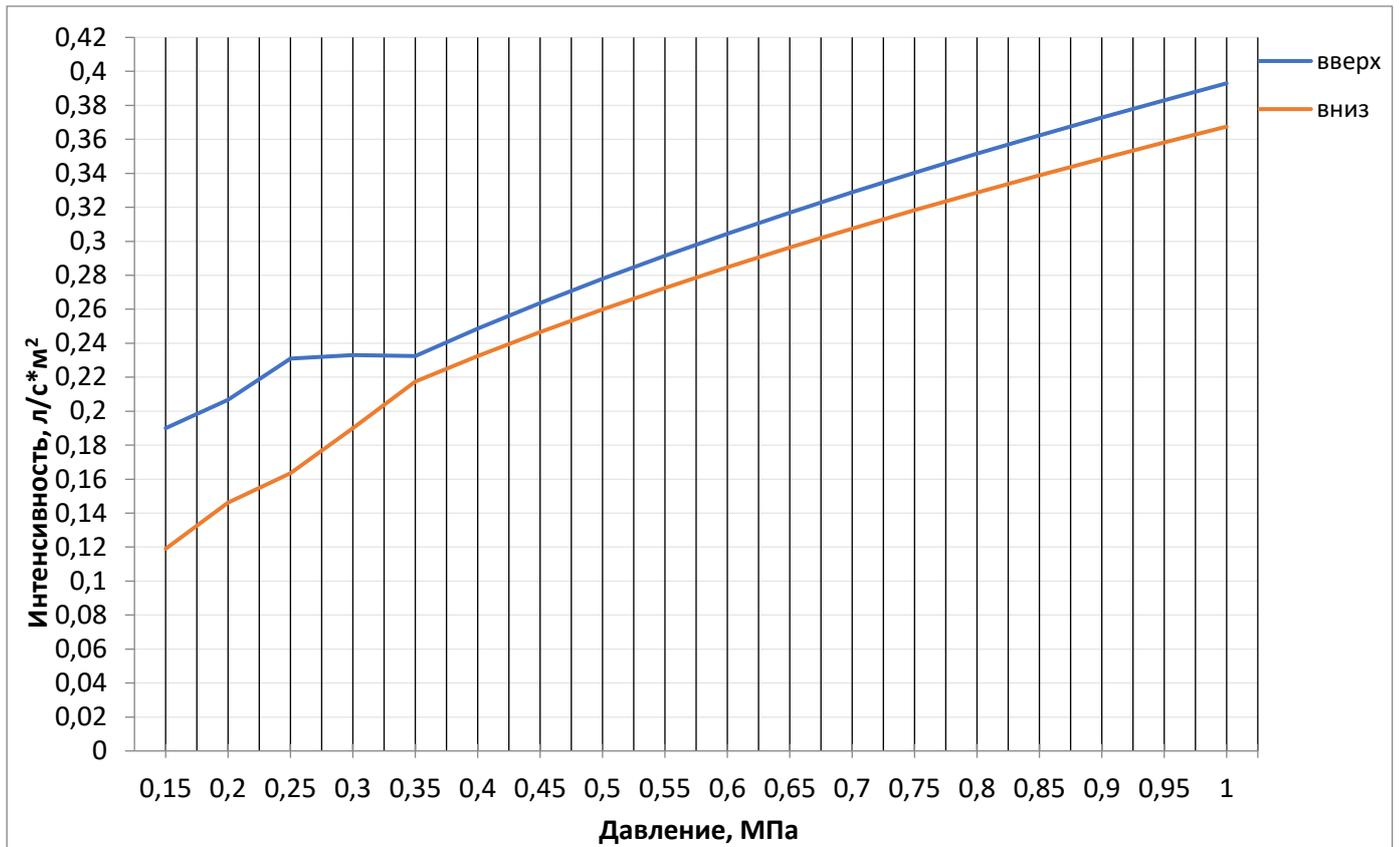
**График зависимости интенсивности орошения от давления на площади 12 м<sup>2</sup>, защищаемой группой оросителей (два и более) с высоты 2,5 м**
